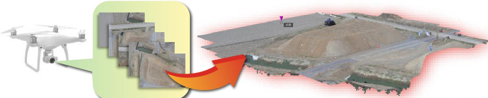
ドローンで空撮した写真から... **三次元点群データを作成!**
